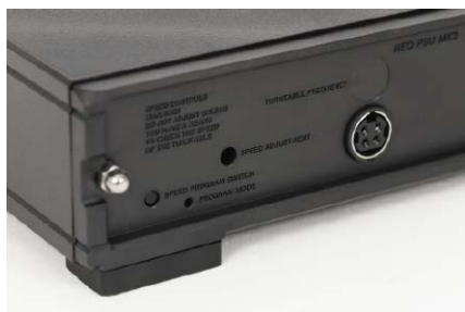
Zasilacz-sterownik (obrotów) umieszczono w niezależnej obudowie.
